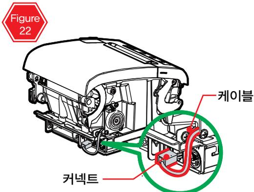
3. 멜로디 보드의 케이블을 그림과 같이 정리를 하고, 커넥터를 메인 보드에 삽입합니다.(fig.22) 케이스 어퍼와 케이스 로어를 해체했던 방법 반대로 재조립 합니다.
